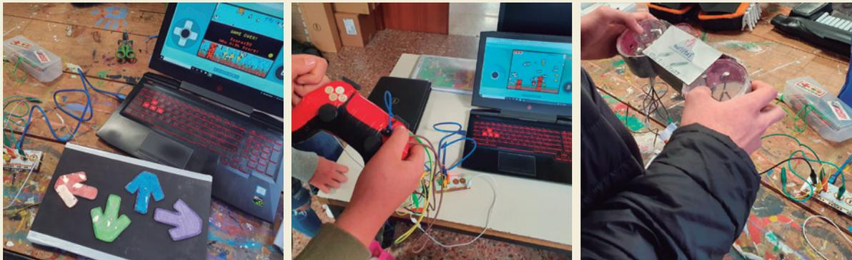
Makecode con el mando construido. Nuestro cuerpo actúa como resistencia, la placa lo detecta y envía una señal al ordenador a través del conector USB, como un código de tecla.
