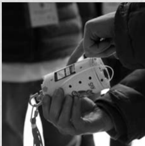
Uno de los satélites creados por los estudiantes. Debían tener el tamaño de una lata y un peso entre los 300 y 350 gramos. JOSÉ ANTONIO GOÑI
